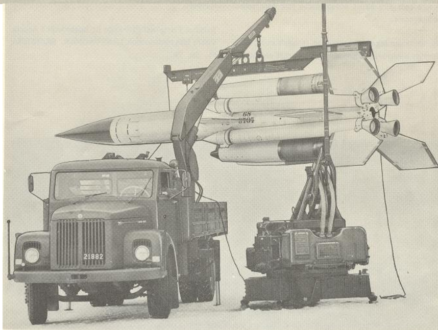
Bild 2. Lastning av robot. Vid lastningen används ett speciellt lyftok
